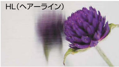
HL(ヘアライン) やや粗い研磨ベルトで研磨目をつけた仕上げ (内装材で使用されています)
