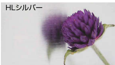
HLシルバー HL(ヘアライン)研磨を行い化学研磨処理 の後アルマイト仕上げしたものの
