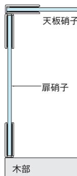
1. ガラスヒンジの取付位置を決め、天板硝子を欠き取りしてください。(硝子の欠き取り寸法参照)又、木部に穴をあけ、受座をしっかりと打ち込んでください。
