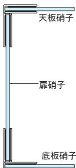
1. 天(底)板硝子を欠き取りしてください。(硝子の欠き取り寸法参照)
