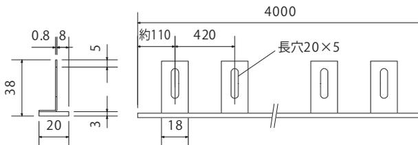
取付金具：端より110mm、以後420mmピッチ、計10個
