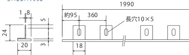
取付金具：端より95mm、以後360mmピッチ、計6個
