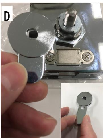
⑤裏カバーと⑥ロックカムを合わせて、錠前ボルト部へセットします。
