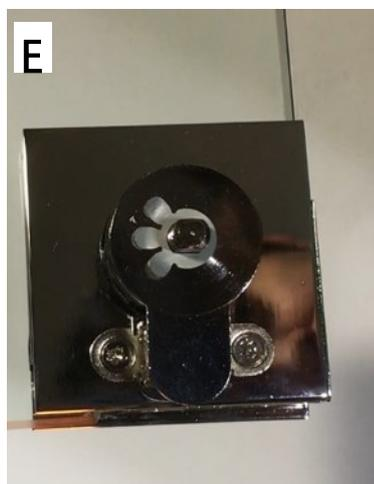
⑦カム用ナット緩み止め平座金をセットします (裏面参照)。その後⑧化粧ナットを固定します。
