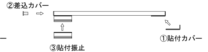
図4. 後引戸の部品の取付
