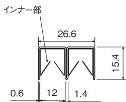
図3 ステン3線防虫レール
