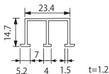
図2 アルミ3線掘込上レール
