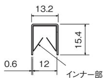
図2 ステン2号防虫レール
