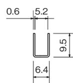
図11 ステン5mm破損止
