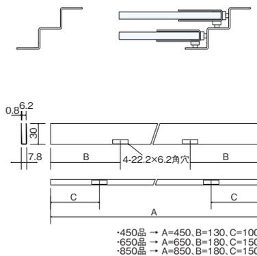
ステンSUS304 天引15mm用30mm取付車・端カバー
