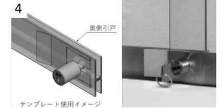
②テンプレートの離型紙を剥がします。図のように溝をピンに当たるところまで挿した後、奥側引戸にテンプレートを貼ります。※引戸が動かないように注意
